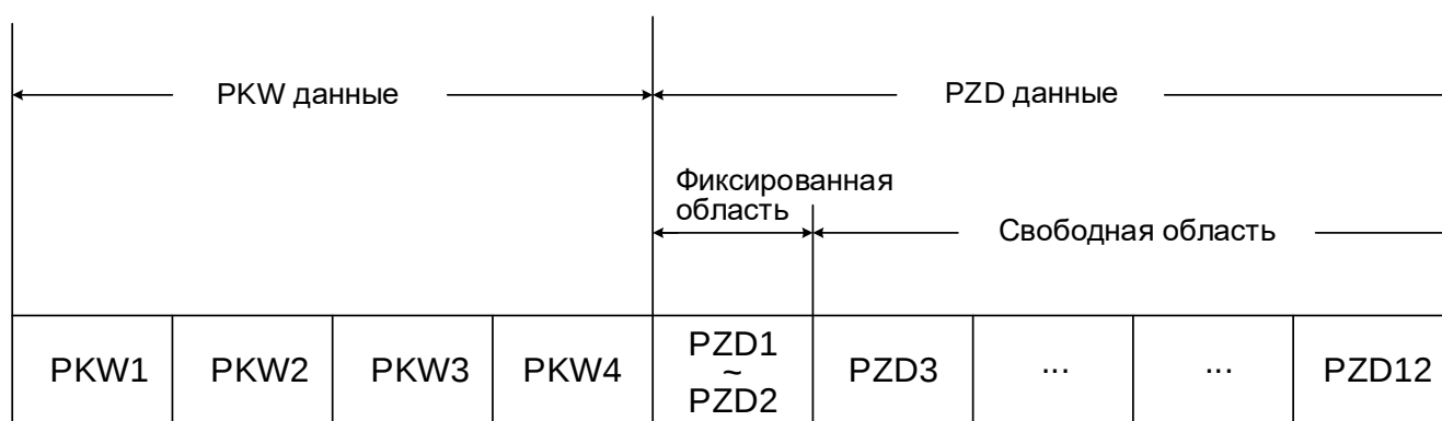
Рисунок 3-1 Структура данных информационного кадра Profibus-DP
