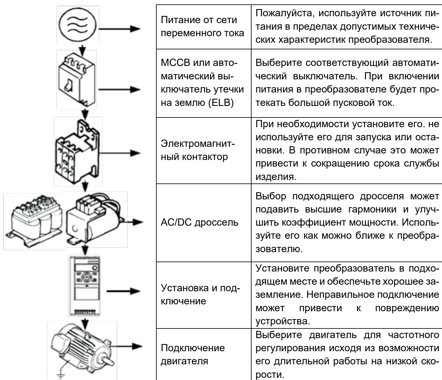
Рисунок 3-1 Схема подключения внешнего оборудования и преобразователя частоты
