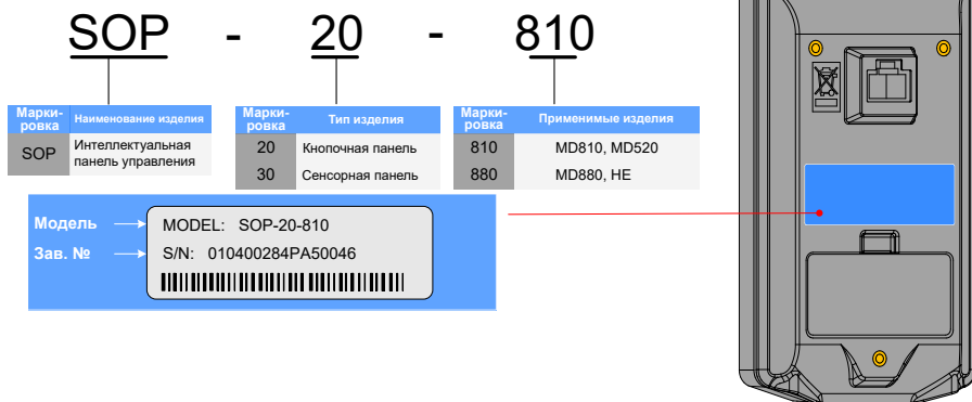
Рисунок 2.1 – Заводская табличка и правила маркировки панели SOP-20
