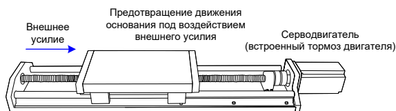
Рис. 4-21 Применение моторного тормоза
